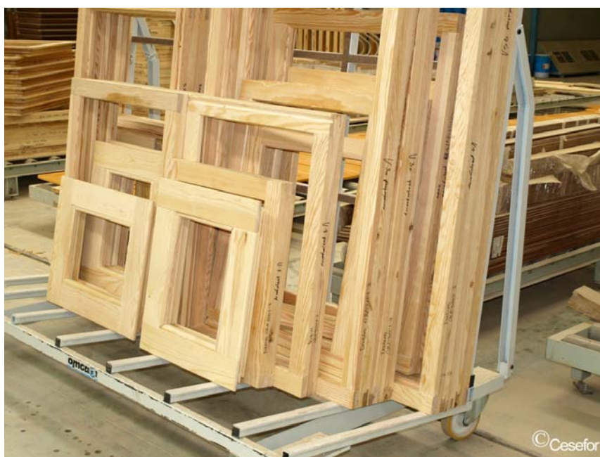
Figura 2: Marcos de ventanas durante su fabricación
